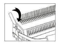
Наденьте пружину на переплетный механизм и при помощи ручки переплета откройте её.
