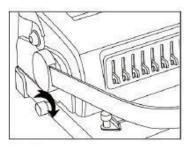
Подготовка к пробивке: Выставьте регулятор глубины пробивка в нужную позицию
